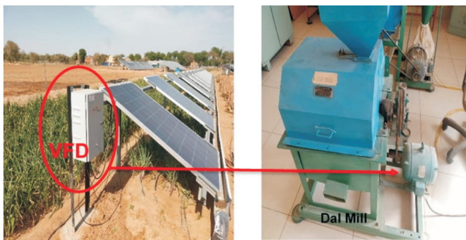
चित्र 8.4 सौर ऊर्जा चलित दाल मिल Fig. 8.4 Solar powered dal mill
