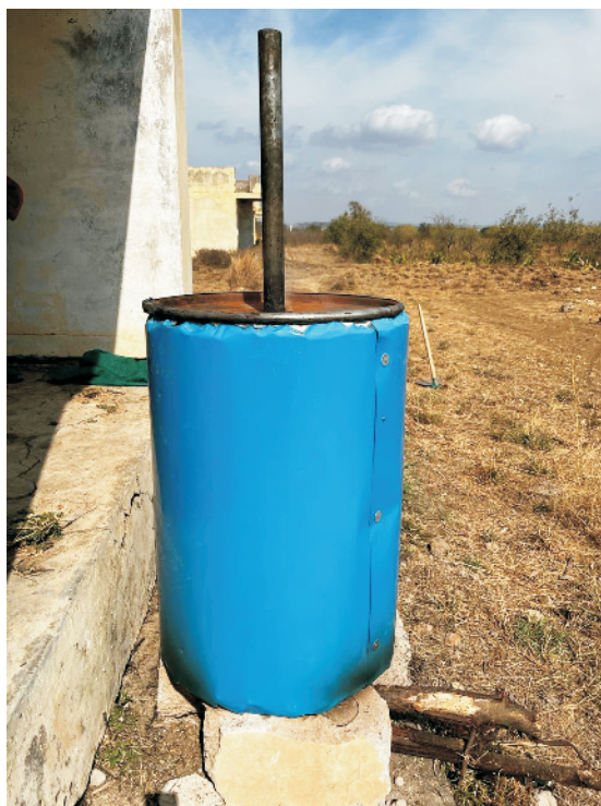
चित्र 3.12 क्षेत्रीय अनुसंधान स्थात्र, भुज पर बायोचार उत्पादन हेतु डिजाइन की गई कम लागत वाली भट्टी Fig. 3.12 Low-cost kiln designed for biochar production at Regional Research Station, Bhuj
