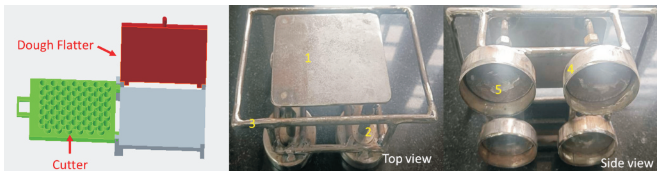
चित्र 8.14 हस्त संचालित बिस्किट आटा कटिंग की कम्प्युटर आधारित डिजाइन और यंत्र (1. पुशिंग प्लेट 2. स्प्रिंग 3. मुख्य फ्रेम 4. बिस्किट कटर इकाई 5. स्प्रिंग लोडेड प्लेट) Fig. 8.14 CAD design and prototype of manual operated biscuit dough cutting (1. Pushing plate 2. Spring 3. Main frame 4. Biscuit cutter unit 5. Spring loaded plate)
