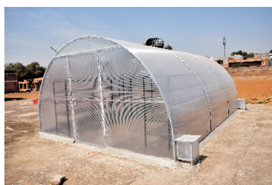
चित्र 8.9 बड़े आकार के सुरंग-प्ररूप पीवी/थर्मल संकर सौर शुष्कक का आरेखण Fig. 8.9 Schematic diagram of large-size tunnel-type PV/thermal hybrid solar dryer
