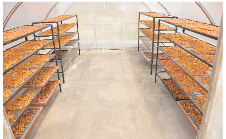
बड़े आकार की सुरंग-प्रकार के फोटोवोल्टाईक तापीय/संकर सौर शुष्कक में खजूर का सुखाना Date palm drying in large-size tunnel-type PV/thermal hybrid solar dryer
