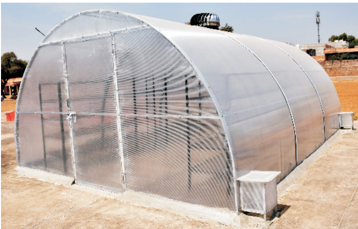
बड़े आकार की सुरंग-प्रकार के फोटोवोल्टाईक तापीय/संकर सौर शुष्कक में खजूर का सुखाना Date palm drying in large-size tunnel-type PV/thermal hybrid solar dryer
